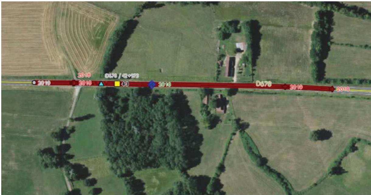
D678 – Le Fay - PR 42+973 - Courbe longue = Zone d'accumulation d'accident par perte de contrôles
