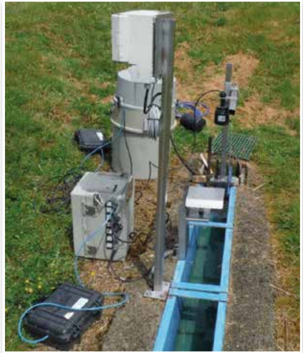
↑ Canaux de mesure de débits en sortie de station d'épuration ↓
